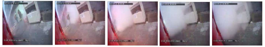
白煙噴出：分解產生氣體、粉塵被分散
